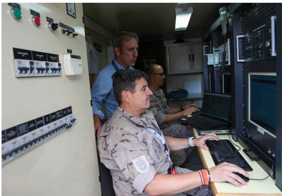
La unidad dispone de dos estaciones Link 16 instaladas en sendos contenedores desplegables para probar y validar la red antes de ponerla a disposición del usuario.
