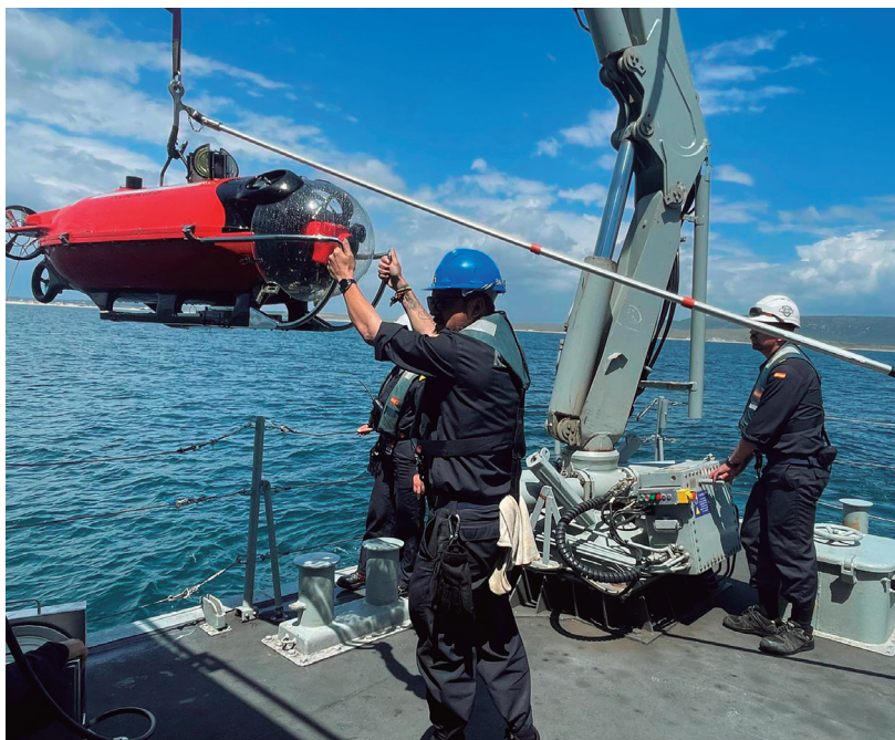
La dotación de un cazaminas lanza el robot submarino Pluto Plus , para comprobar la existencia de artefactos explosivos en el fondo marino.
