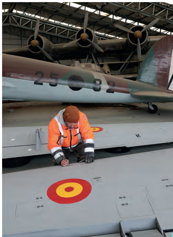
Últimos retoques a pincel en el ala de un avión. Con estos detalles se busca que la nave se aproxime lo máximo posible a su aspecto original.
