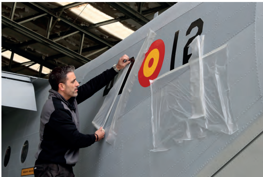
Fijación de los emblemas en el Aviocar TM-12 —preparado para la guerra electrónica—, última etapa de su proceso de recuperación en el hangar.
