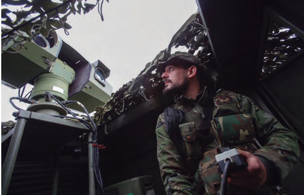
El puesto de observación móvil (POMO), equipado con un sistema oprtrónico de visión,
